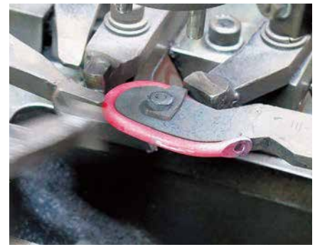
硬鋼線材を切断し、糸を通す穴を開けた後、炎で焼き鍛え真っ赤になった針を1本ずつセットし、釣り針型に曲げる
