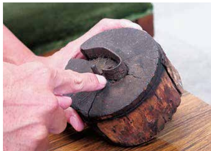
機械化される前は、この型に当てて「し」の字に針を曲げていた
