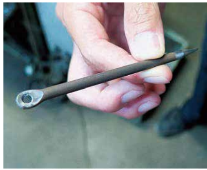
硬鋼線材を切断し、糸を通す穴を開けた後、炎で焼き鍛え真っ赤になった針を1本ずつセットし、釣り針型に曲げる
