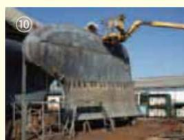
⑩バルバス 船の造波抵抗を打ち消すために、喫水線下の船首に設けた球状の突起。球状船首ともいう。これがあると造波抵抗を小さくでき、航行速度の向上と燃費向上が図れるため、船にとっては重要な部分になる。写真の中のバルバスは上下逆さで工事しています。実際は船底のほうが出っ張るような形になります。
